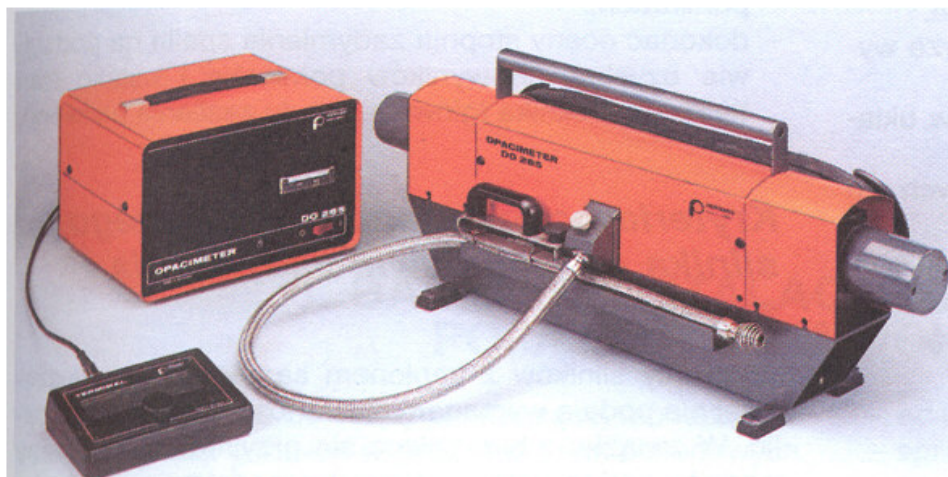
Rys.4 Elementy składowe dymomierza absorpcyjnego DO 285 (komora pomiarowa, moduł pomiarowy z drukarką i terminal z wyświetlaczem ciekłokrystalicznym)
